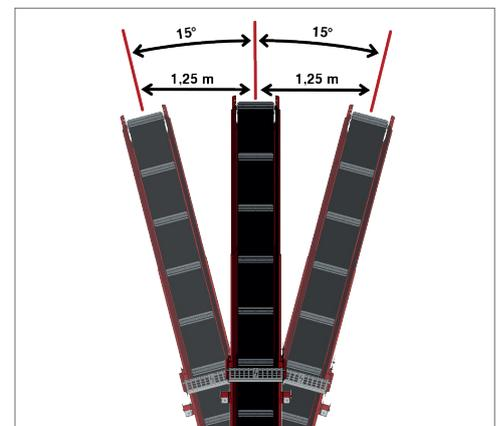
Das schwenkbare Förderband ermöglicht eine einfache und praktische Beladung des Anhängers oder der Gitterboxen. Die Steuerung des Förderbandes befindet sich direkt neben der Hauptsteuerung der Säge.
