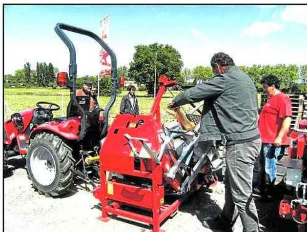
Mobilité maximale pour la Solomat qj peut être transportée et actionnée par un tracteur
