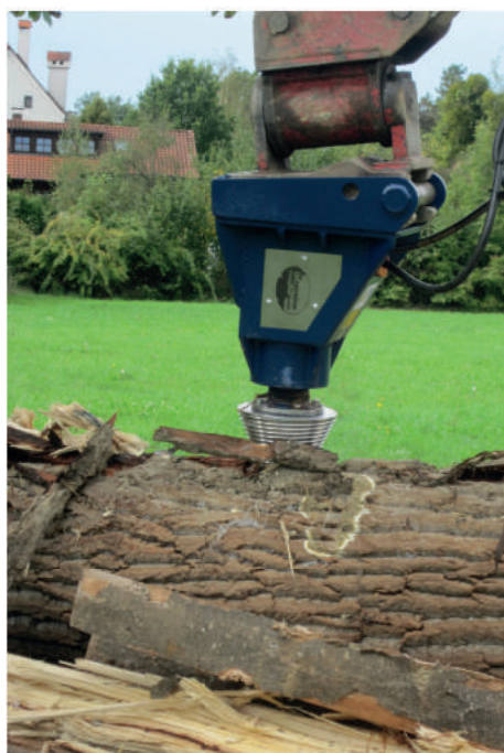
Vis de Ø 200 mm (filetage à double tranchant) pour KB 800 et KB-S 800
