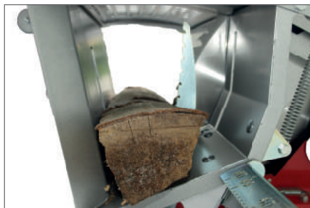
Bras de maintien du bois pendant l'opération de sciage
