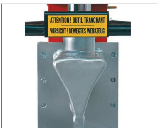
Couteau ergonomique de forme éclateur pour fendre avec moins d'effort. Incliné pour favoriser le maintien du bois.
