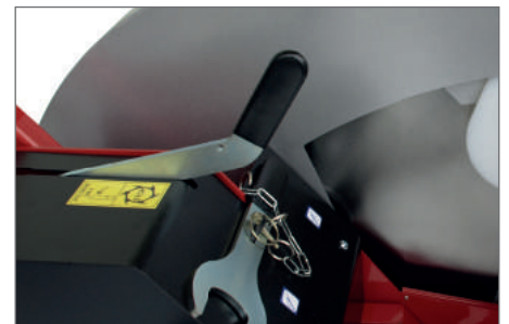
Levier d'arrêt d'urgence à la prise de force
