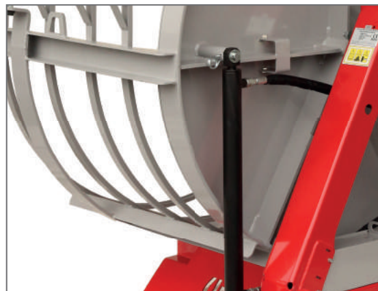
Basculement hydraulique (gauche ou droite)
